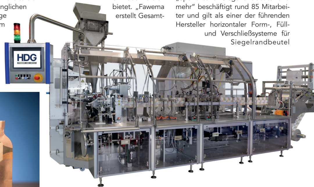
Die horizontale Form-, Füll- und Verschleißmaschine RB-200 von HDG mit Push&Dose-Beutel (l.). (Bilder: TPG) The horizontal form, fill and seal machine RB-200 from HDG with Push&Dose pouch (left). (Images: TPG)
